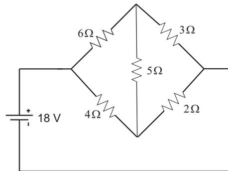
Pelo resistor de 5 Ω, passa uma corrente elétrica cujo valor, em A, vale:
