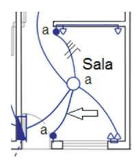
Considere que, no eletroduto onde há indicação de condutores, esta foi feita de forma completa. De a c o r d o c o m a s i m b o l o g i a d a n o r m a ABNT NBR 5444:1989 (Símbolos gráficos para instalações elétricas prediais), no eletroduto indicado pela seta, devem passar os seguintes condutores:
