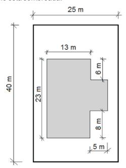
De acordo com a norma ABNT NBR 8036:1983 (Programação de sondagens de simples reconhecimento dos solos para fundações de edifícios — Procedimento), o número mínimo de sondagens deve ser:
