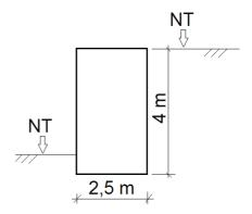
Considerando-se que o solo arrimado tem coeficiente de empuxo ativo igual a 1/3 e peso específico de 18 kN/m³, adotando-se o coeficiente de atrito entre o solo e o muro igual a 0,48 e desprezando-se o empuxo passivo, o coeficiente de segurança ao deslizamento desse muro é igual a:
