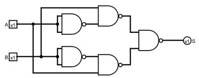
Considerando as entradas A e B e a saída S, ele é equivalente, em funcionalidade, a apenas uma porta lógica que opera sobre as entradas A e B gerando S. Essa porta lógica é uma
