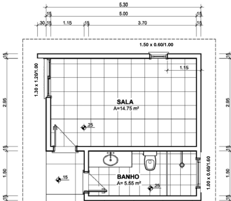
A edificação representada na figura possui pé direito e altura de alvenaria iguais a 2,80 m. Os cálculos aproximados em  $m^2$  das áreas de revestimento (WC), de Emboço (WC) e do reboco interno e externo da edificação, respectivamente, são:
