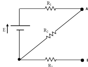
Entre os terminais A e B será ligada uma carga resistiva. O valor dessa carga e a potência a ser dissipada por ela, de modo que essa potência seja máxima são, respectivamente iguais a
