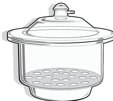
O dessecador é utilizado para a secagem de sólido se, na parte inferior, forem colocadas substâncias que absorvem água, a exemplo da sílica gel e do ácido sulfúrico.
