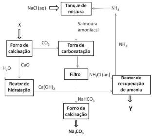
O reator principal do processo é o reator de carbonatação, onde ocorrem diversas reações, cuja equação global é:
