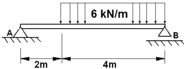
Considerando que o peso da viga pode ser desprezado, é correto afirmar que os valores da FORÇA CORTANTE (em kN) e do MOMENTO FLETOR (em kNm) que atuam na seção transversal da viga que dista 4 metros do apoio **A** são, respectivamente:
