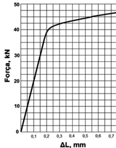
Uma barra fabricada com essa liga, com 10 metros de comprimento e com seção resistente quadrada de 5 mm de espessura, é submetida a um carregamento em tração uniaxial de intensidade de 7,5 kN. O aumento de comprimento, em mm, gerado na barra por esse carregamento é de, aproximadamente:
