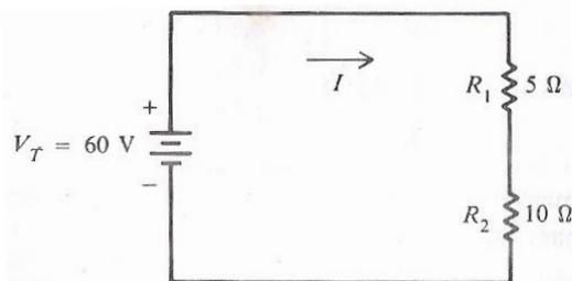
A potência total  $P_T$  dissipada por  $R_1$  e  $R_2$  é igual a:
