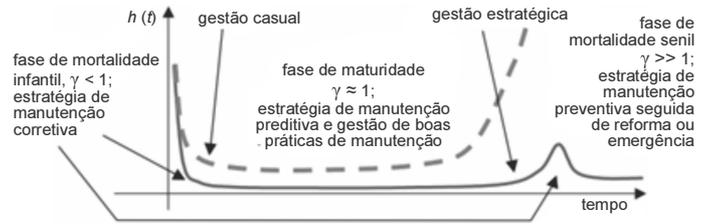
Considerando a figura acima, que representa uma curva de banheira, julgue os itens subsequentes, relativos à manutenção centrada na confiabilidade, função, falha, falha funcional e modo de falha.
