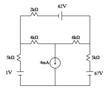
O valor da corrente elétrica que flui pelo resistor 6 k $\Omega$ , em mmA, vale:
