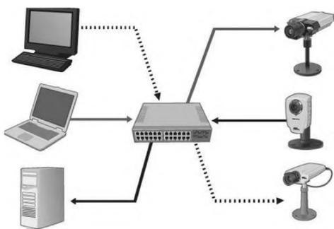
O equipamento central ao qual os computadores e as câmeras estão ligados em uma mesma rede faz com que a transferência de dados seja gerenciada de maneira eficiente, de modo que o tráfego de dados possa ser direcionado de um dispositivo para outro sem afetar nenhuma outra porta desse equipamento. Baseado na imagem e nas informações fornecidas, pode-se concluir que o equipamento central é um:
