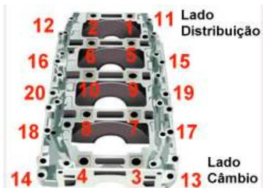
PARAFUSOS DE FIXAÇÃO DO BLOCO INFERIOR AO BLOCO MOTOR
