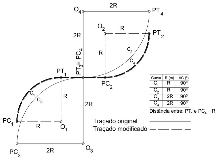
A figura acima representa o traçado geométrico em planta formado por curvas circulares simples. Considere que o traçado geométrico foi modificado e as curvas horizontais circulares simples C<sub>1</sub> e C<sub>2</sub> foram substituídas pelas curvas C<sub>3</sub> e C<sub>4</sub> respectivamente.
