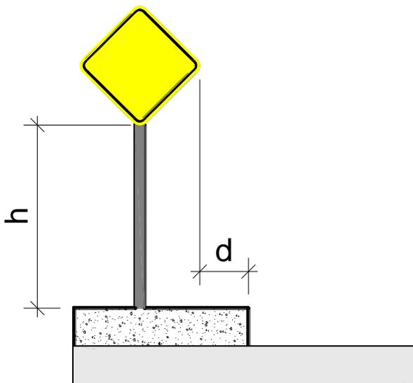
De acordo com o Manual de Sinalização Vertical de Advertência, a placa colocada lateralmente à via urbana, em trecho reto, tem as dimensões mínimas para altura livre ( $h$ ) e afastamento lateral ( $d$ ) **respectivamente** iguais a
