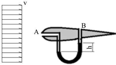
Qual das expressões a seguir permite calcular a velocidade,  $v$ , do escoamento usando a indicação,  $h$ , no manômetro diferencial? Considere que a diferença de cota entre os pontos A e B é muito pequena.
