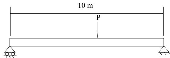
Considerando somente a carga estática e a situação mais crítica em termos de momento fletor, qual seria o máximo valor da carga levantada, P, sabendo que a tensão normal admissível para o material desta viga é igual a 375 MPa?
