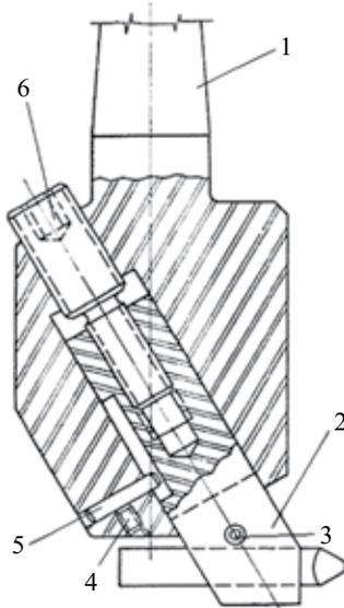
Ao girar a peça 6, qual o será o movimento da peça 2, sabendo que o corpo do dispositivo, peça 1, permanece fixo?
