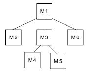
A sequência de testes adotada foi M1, M2, M3, M6, M4, M5. Essa sequência é denominada de integração
