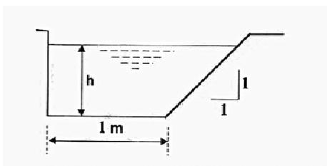
Assinale a alternativa que indica a altura da lâmina d'água  $h$ , de modo que a altura hidráulica  $H_m$  seja 41% maior que o raio hidráulico  $R_h$  da seção.
