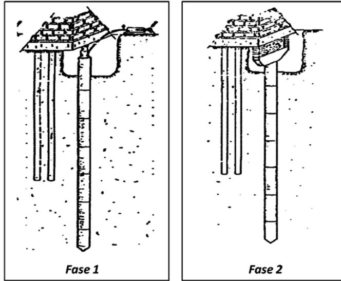
No processo ilustrado, a estaca é constituída de elementos justapostos (de concreto armado, protendido ou de aço) que são ligados uns aos outros por emenda especial e cravados sucessivamente por meio de macacos hidráulicos. Os referidos elementos ainda buscarão reação sobre a estrutura existente ou na estrutura que esteja sendo construída. Neste contexto, é possível afirmar que trata-se de estaca tipo
