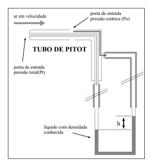
A pressão estática no local dos testes era 760 mm de Hg e a densidade do ar no dia dos testes era de 1,0 kg/m³, o desnível máximo registrado na coluna do manômetro diferencial utilizando um fluído manométrico com densidade de 8000 kg/m³ foi de 25 mm. Nessas condições, a velocidade máxima atingida pelo veículo foi
