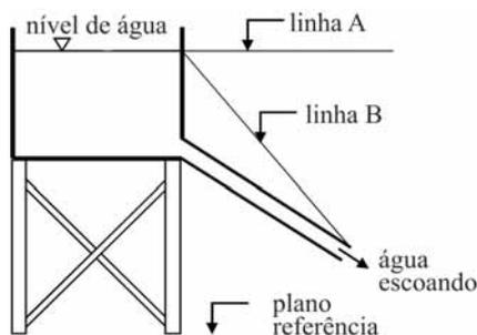
A figura acima representa um grande reservatório de água, com canalização aberta conectada abaixo dele, permitindo o escoamento do líquido.
