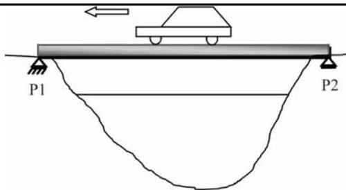
A figura acima representa uma ponte de madeira de peso  $M$ , de mesma seção reta em toda sua extensão, biapoiada nas extremidades  $P_1$  e  $P_2$ , sendo  $P_1$  um apoio de 2.º gênero e  $P_2$  um apoio de 1.º gênero. Um carro de peso  $F$  se desloca sobre a ponte no sentido mostrado na figura. Em relação a essa situação, julgue os itens a seguir.
