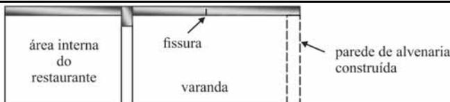
Em determinado restaurante, para melhorar o conforto dos clientes, o dono desejou fechar a varanda, cuja cobertura consiste em uma grande laje de concreto em balanço, conforme ilustrado na figura acima. Para execução dessa reforma, foi construída uma parede de alvenaria. Após a construção, verificou-se o surgimento de uma fissura na laje, como indicada no desenho. A respeito dessa situação, julgue os itens seguintes.
