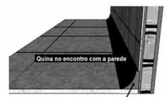
Figura II: rodapé feito depois do piso
