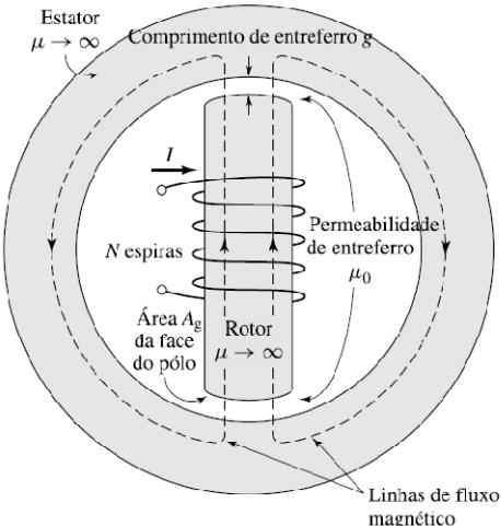
Considere que a permeabilidade do ferro do rotor e do estator são infinitas e que  $\mu = 4\pi \cdot 10^{-7}$ .
