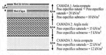
Considerando-se esse problema, os valores de tensão vertical efetiva, na profundidade média da camada argilosa, antes da construção, logo após a construção e após o término do adensamento, são, respectivamente:
