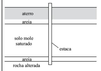
Sabendo-se que as estacas foram executadas antes do aterro, o efeito que a construção do aterro provoca é:
