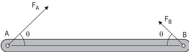
A barra rígida de um mecanismo está sujeita a duas forças,  $F_A$  e  $F_B$ , atuantes nos pinos A e B, respectivamente, conforme indicado na figura.
