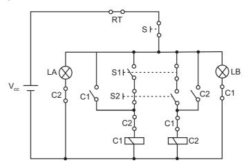
A figura acima apresenta o circuito elétrico de comando de um motor trifásico com controle do sentido de rotação. Com relação a este circuito, considere as afirmações.
