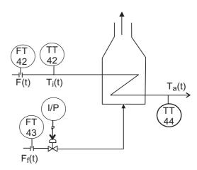
A figura acima apresenta um diagrama contendo os símbolos dos instrumentos de medição instalados numa fornalha. Estes símbolos representam:
