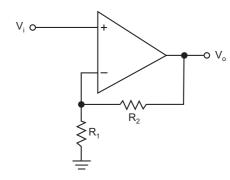
No circuito da figura, considere o amplificador operacional ideal,  $R_1$ =10k $\Omega$  e  $R_2$ =20k $\Omega$ . O ganho de tensão  $\frac{V_o}{V_i}$  é:
