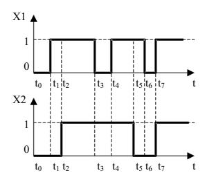
A figura acima mostra o programa em diagrama de contatos implementado num CLP e os gráficos temporais dos sinais X1 e X2. Em  $t = t_0$ , todas as variáveis encontram-se em nível lógico 0. O comportamento correto para Y1 é:
