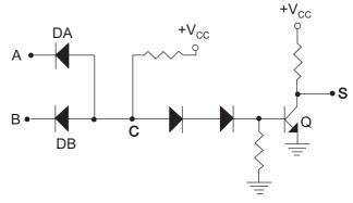
Convencionou-se **ON** para o estado de condução do diodo ou saturação do transistor e **OFF** para o estado de corte dos componentes.
