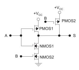
O circuito da figura acima é montado usando-se a tecnologia MOS e representa uma porta lógica que implementa a função:
