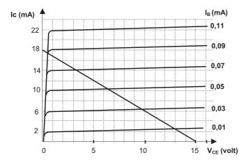
As figuras mostram um circuito transistorizado operando na região ativa com  $V_{\rm BE}$ =0,6 V e as curvas características do transistor com a reta de carga correspondente.
