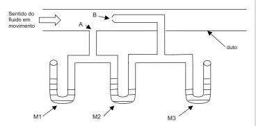
A figura apresenta um esquema de medição das pressões sobre um fluido em circulação num duto. O orifício A é um orifício de pressão com eixo perpendicular à corrente do fluido. O orifício B está colocado no sentido oposto da corrente do fluido. M1, M2 e M3 são manômetros de tubo em "U", sendo que M1 e M3 possuem uma de suas extremidades abertas, como indicado na figura.
