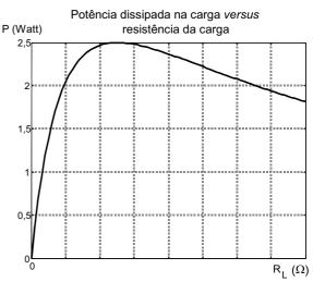
O gráfico ilustra a potência dissipada em watts sobre uma carga resistiva  $R_L$ , na medida em que sua resistência é variada. A carga encontra-se em série com uma fonte de tensão de 5 V e resistência interna  $R_S$ . O valor da resistência interna  $R_S$  da fonte, em ohms, é:
