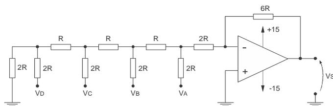
Com  $V_D = 0V$ ,  $V_C = 5V$ ,  $V_B = 0V$  e  $V_A = 5V$ , a saída  $V_S$  é, em volt, igual a:
