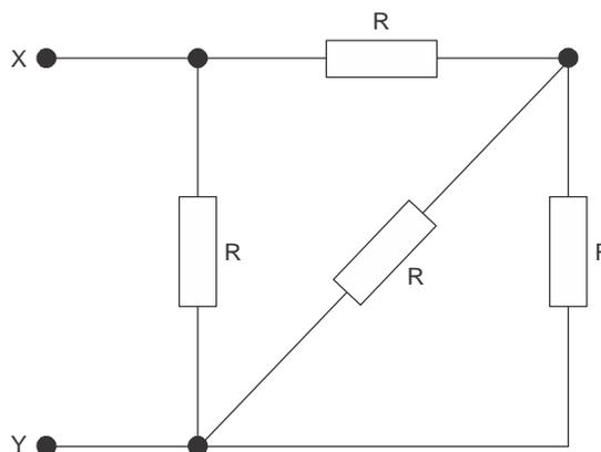
Sendo R = 10 kΩ, a resistência equivalente entre os pontos X e Y vale
