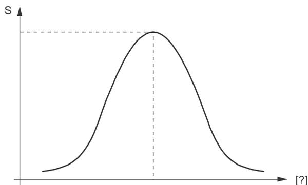
Para utilizá-lo em um sistema de comunicação composto também por fibra óptica e LED infravermelho, deve-se levar em conta o gráfico acima, obtido em *datasheet*, em que a grandeza S no eixo da ordenada representa a *relative spectral sensitivity* e a grandeza da abscissa corresponde a
