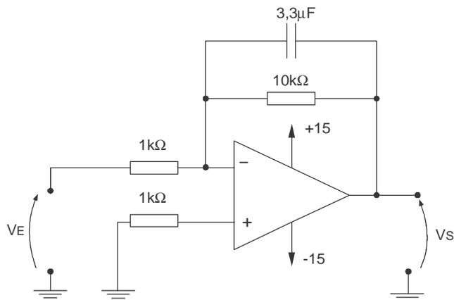
A frequência limite ou de corte, para que o circuito funcione como integrador é, aproximadamente:
