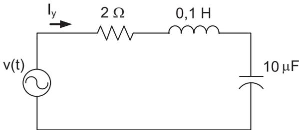
No circuito da figura, a fonte é ideal, e sua tensão é dada por  $v(t) = 120\sqrt{2} \cos(1000 t)$  volts.
