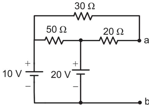
No circuito de corrente contínua da figura, a tensão, em V, entre os pontos a e b é
