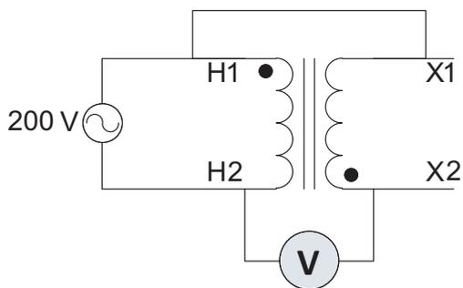
A figura apresenta um ensaio num transformador monofásico de 50 kVA, 200/10 V, 60 Hz. Nesse ensaio, os terminais H1 e X1 estão em curto-circuito, e um voltímetro é conectado nos terminais H2 e X2. Os terminais de tensão superior são alimentados por uma fonte de tensão alternada com a tensão nominal do transformador. Considere o transformador ideal.
