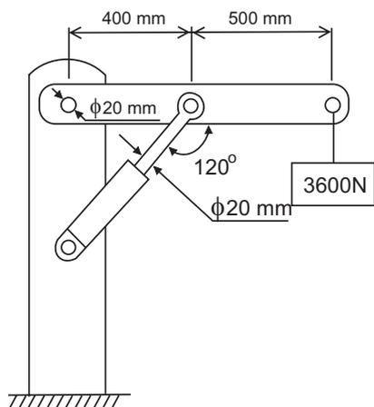
Qual a tensão de cisalhamento devido a esforço cortante, em MPa, no pino, entre a coluna e a lança?
