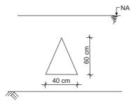
O empuxo exercido pelo líquido com  $\gamma=10x10^3 N/m^3$  sobre a placa de vidro vertical acima esquematizada, cuja base se encontra a 3,20m de profundidade, em kN, vale:
