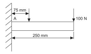
Um técnico resolve posicionar um bloco em uma viga engastada, submetida a uma carga de 100 N em sua extremidade, afastada 75 mm do engaste.
