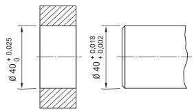
A figura representa um ajuste entre um eixo e um furo.
