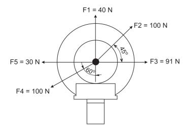
Um olhal é um componente mecânico muito utilizado no içamento de cargas através da utilização de cabos de aço. Considerando o olhal sob a ação de um sistema de forças, representado na figura acima, o valor da resultante, em N, atuante é
