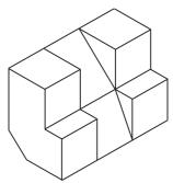
Acima está representada a perspectiva isométrica de uma peça.
