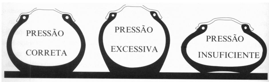
Ilustração da conformação do pneu em função da pressão de inflação. Fonte: Lanças
