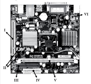
Os pontos identificados por II e V referem-se, respectivamente, aos *slots* para conexão dos seguintes dispositivos:
