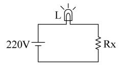
Considerando que a lâmpada L foi projetada para funcionar numa rede de 120 V, dissipando 60 W, o valor da resistência Rx, que garanta o funcionamento nominal da lâmpada L, é
