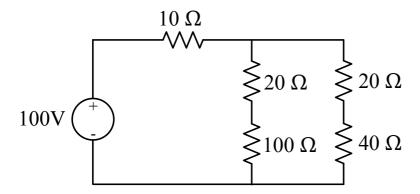
A queda de tensão aproximada no resistor de 40  $\Omega$  é:
