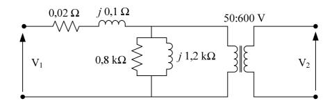
Um transformador monofásico, com potência nominal igual a 10 kVA, 60 Hz e relação de transformação 50 V/600 V, foi submetido aos ensaios de curto-circuito e a vazio, obtendo-se o circuito elétrico linear equivalente, em baixas frequências, com parâmetros referenciados ao lado de baixa tensão, conforme mostrado na figura acima. Com base nestas informações, julgue as proposições abaixo.
