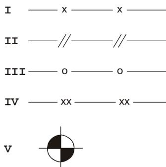
Segundo a norma NBR 13133/1994, que fixa as condições exigíveis para a execução de Levantamento Topográfico, em seu Anexo B – Convenções Topográficas, tendo em vista o desenho topográfico final, os símbolos representados por I, II, III, IV e V referem-se, respectivamente, a cerca
