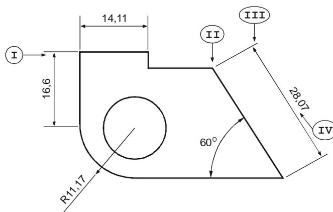
No software AutoCAD, antes de cotar um desenho, faz-se necessário ajustar a configuração das cotas no que se refere a limites de cotas e medidas das linhas, entre outras. De acordo com a caixa de diálogo aberta com o comando *Dimension Style*, em software tipo CAD, os itens I, II, III e IV são chamados, respectivamente, de
