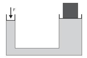
Considere um elevador hidráulico, conforme mostrado na figura acima. Para erguer um bloco de peso P = 50.000 N, apoiado na plataforma de área  $A_2 = 500$  cm², qual é o módulo mínimo de Força, em newtons, que deve ser aplicado no êmbolo de área menor,  $A_4 = 25$  cm²?
