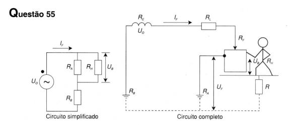
A resistência de aterramento da alimentação ( $R_B$ ) é pequena (1 a  $10\Omega$ ) em comparação com a resistência do corpo humano ( $R_H$ ), geralmente maior que  $1000\Omega$ .
