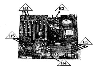
Se um técnico em informática precisa instalar uma placa de rede 10/100 Mbps e uma placa de memória DDR2 de 2GB, ele deve utilizar, respectivamente, os slots identificados por:
