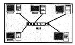
Quando o nó central é um hub, este obtém um sinal que vem de qualquer estação em um nó e o passa adiante para todos os outros nós da rede. Um hub não faz nenhum tipo de roteamento ou filtragem de dados, contrariamente ao switch, que executa filtro de tráfego. Ele simplesmente une os diferentes nós. Do ponto de vista físico, essa topologia é conhecida por:
