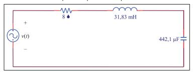
No circuito elétrico mostrado na figura acima, todos os componentes são ideais e a tensão da fonte — v(t) — é senoidal, tem amplitude igual a 311,13 V, freqüência igual a 60 Hz e ângulo de fase igual a 30°. O gráfico abaixo mostra as formas de onda das potências relacionadas aos três elementos da carga RLC em função do tempo.
