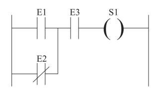
A figura anterior mostra um diagrama de contatos de um controlador lógico programável (CLP), em que os componentes designados por E são entradas e o componente designado por S é uma saída. Assinale a opção que apresenta a tabela da verdade correspondente a este diagrama de contatos.
