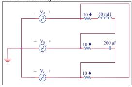
A figura acima mostra um circuito elétrico trifásico em que a fonte é senoidal equilibrada e todos os componentes são ideais. Com relação a esse circuito, assinale a opção incorreta.
