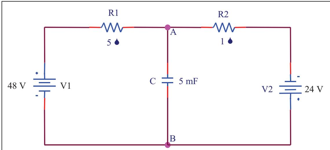
No circuito elétrico mostrado na figura acima, que está funcionando ininterruptamente há mais de trinta horas, todos os componentes são ideais.
