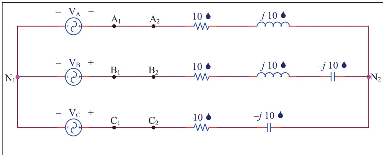
A figura acima mostra um circuito elétrico trifásico em que a fonte é senoidal equilibrada, tem frequência igual a 60 Hz, possui tensão de fase com amplitude igual a  $200\sqrt{2}$  V e seqüência de fases ABC.
