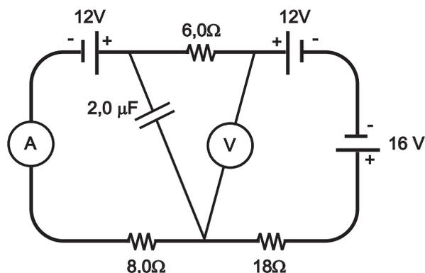
Para o circuito acima, as leituras no Amperímetro e no Voltímetro, e a carga no capacitor, considerando-se que ambos os aparelhos sejam ideais, são
