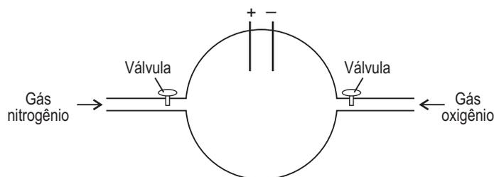
Certa quantidade dos dois gases foi admitida no reator até que, a uma dada temperatura  $T_1$ , as pressões parciais dos gases fossem iguais. Nesse instante, as duas válvulas foram fechadas. Quando o arco elétrico é ligado, os gases reagem formando o produto com rendimento de 100%. Considerando-se o comportamento ideal para todos os gases, após a reação retornar a temperatura  $T_1$ , a pressão final do sistema é igual à(ao)
