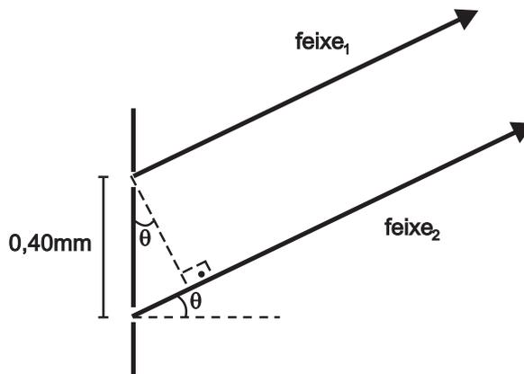
Duas fendas horizontais, paralelas, distantes entre si de 0,40 mm, são iluminadas por um feixe de luz de 400 nm que incide perpendicularmente ao plano onde se localizam as fendas. Parte da luz difratada de certos ângulos  $\theta$  é cancelada. O menor valor de  $\text{sen}(\theta)$  para o qual ocorre a interferência destrutiva entre os feixes provenientes das duas fendas é
