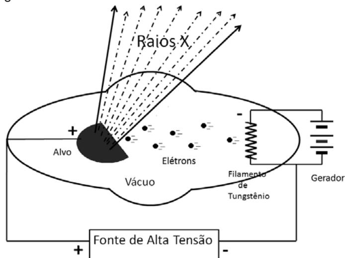
No interior do tubo, elétrons são liberados de um filamento aquecido de tungstênio por efeito termoiônico e acelerados por uma fonte de alta tensão, indo colidir, com alta energia, contra um alvo metálico. Durante a desaceleração dos elétrons, são produzidos os Raios X. Quando a fonte de alta tensão fornece diferença de potencial de 40 kV, qual o comprimento de onda mínimo de um fóton de Raios X produzido?
