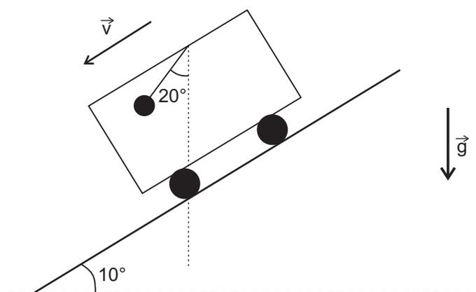
No teto do automóvel, foi instalado um pêndulo simples, e, de volta à pista em declive do local do atropelamento, o motorista conduziu o veículo e acionou os freios, da mesma forma como ocorreu no dia do evento. Durante a frenagem, o fio do pêndulo fez um ângulo de  $20^\circ$  com a vertical. Sabendo-se que a pista em declive faz com a horizontal um ângulo de  $10^\circ$ , qual o verdadeiro valor do coeficiente de atrito entre a pista e os pneus do automóvel?
