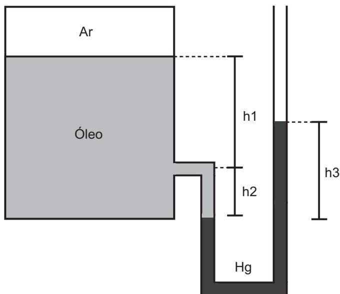
O tanque fechado mostrado na figura acima contém ar comprimido e óleo de densidade relativa 0,9. Utiliza-se mercúrio, cuja densidade relativa é de 13,6, como fluido manométrico no manômetro em U. Se  $h_1 = 952$  mm,  $h_2 = 136$  mm,  $h_3 = 230$  mm, e se a pressão atmosférica no local mede 740 mmHg, a pressão do ar comprimido, em mmHg, é
