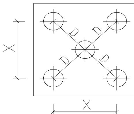
**58.** Supondo-se que você necessite definir o tipo de fundação de uma obra, optando entre sapatas isoladas na profundidade de 1,0m e estacas tipo raiz na profundidade de 6,0 m, baseada em análise simples de menor custo. Tomando como base pilares com carga média de 30 tf, que exigiriam sapatas com base quadrada de 1,60 m de lado e altura constante de 0,80 m e, no caso de estacas, uma estaca de 25 cm de diâmetro com um bloco de coroamento de seção 0,60 m x 0,60m x 0,70m.
