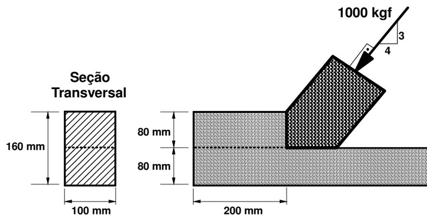
Para a componente horizontal da carga axial, os respectivos e corretos valores que surgem para a tensão normal de compressão média na área de contato e para a tensão de cisalhamento média ao longo do plano definido pela linha tracejada, são:
