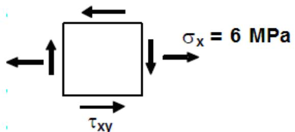
Sabendo-se que a tensão normal máxima é igual a 8 MPa, o valor da tensão de cisalhamento ( $\tau_{xy}$ ) correspondente à tensão normal  $\sigma_x = 6$  MPa será igual a
