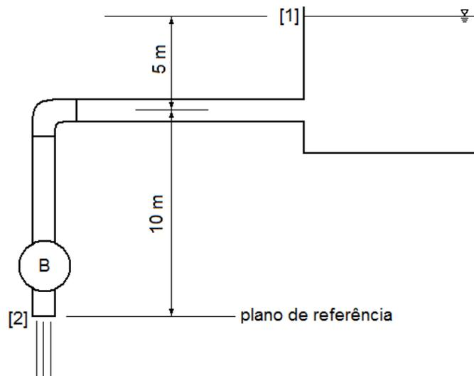
A água é descarregada à atmosfera, na seção [2], com uma velocidade de  $15\text{ m/s}$ . Sabe-se que a área da seção de todos os tubos da instalação é  $10\text{ cm}^2$ . As seções [1] e [2] estão submetidas apenas à pressão atmosférica. Considere que o peso específico da água vale  $10^4\text{ N}/\text{m}^3$  e a aceleração da gravidade é igual a  $10\text{ m/s}^2$ .
