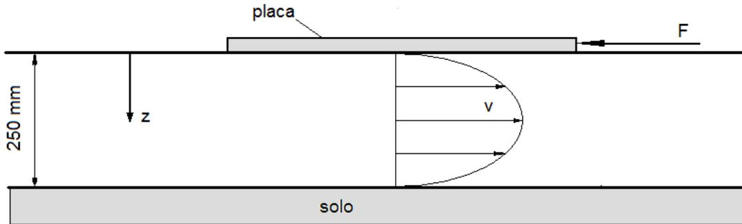
A placa possui área de  $8\text{m}^2$  e espessura desprezível. O fluido escoar formando um diagrama de velocidades que pode ser representado pela seguinte equação:
