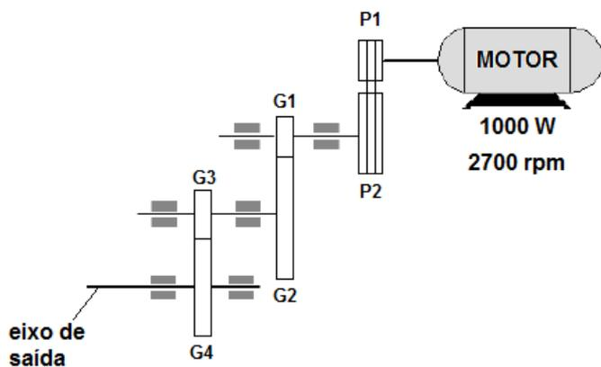
Sabendo que a potência do motor é de 1000 W e gira a 2700 rpm, o torque no eixo de saída é
