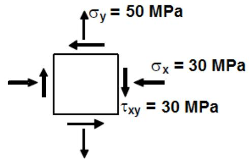
A tensão máxima de cisalhamento ( $\tau_{m\acute{a}x}$ ) e as tensões principais ( $\sigma_1$  e  $\sigma_2$ ) valem, respectivamente
