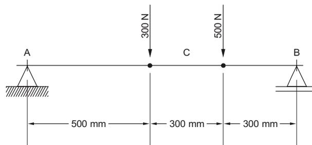
Para a barra esquematizada, onde são aplicadas duas forças pontuais, uma de  $300\text{ N}$  e outra de  $500\text{ N}$ , conforme indicado na figura acima, o valor do *momento fletor* no ponto "C", que se encontra a  $550\text{ mm}$  das extremidades, corresponde a
