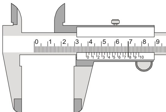
A leitura correta do paquímetro, conforme indicado, corresponde a
