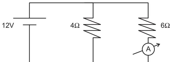
No circuito elétrico acima, dois resistores cujas resistências valem, respectivamente,  $4,0 \Omega$  e  $6,0 \Omega$ , estão ligados em paralelo e conectados a uma bateria de 12 V. Qual a corrente elétrica que é marcada no amperímetro?
