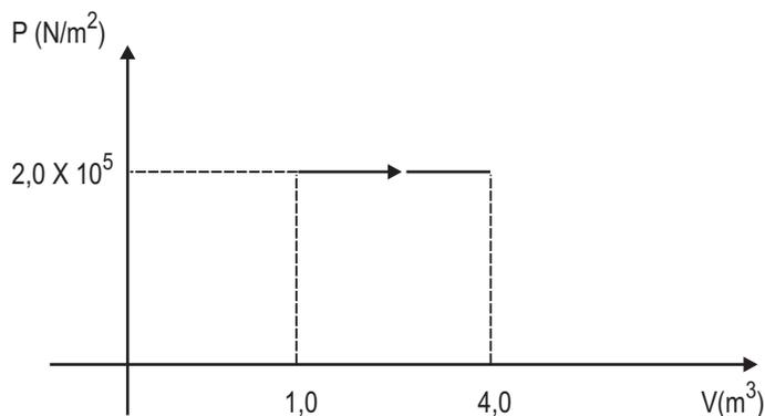
Um gás ideal sofre uma expansão a pressão constante, onde o volume inicial é  $1,0\text{ m}^3$  e o volume final é  $4,0\text{ m}^3$ . A pressão ao longo do processo é  $p = 2,0 \times 10^5\text{ N/m}^2$ , conforme mostrado no gráfico acima. Qual o trabalho realizado pelo gás?
