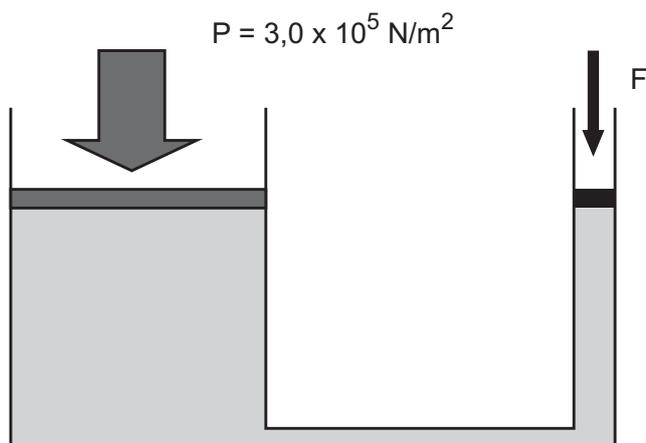
Um reservatório contendo água no seu interior, possui a forma mostrada acima, onde ambas as partes laterais são dotadas de êmbolos livres para se deslocarem sem atrito. Na parte da direita, a área da seção transversal é de  $50 \text{ cm}^2$  e, na esquerda, uma pressão de  $3,0 \times 10^5 \text{ N/m}^2$  é exercida, fazendo o êmbolo esquerdo se deslocar para cima. Qual é a força  $F$  que tem de ser exercida para manter o êmbolo esquerdo em repouso?
