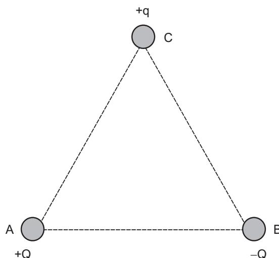
Duas esferas idênticas, carregadas eletricamente com carga de módulos iguais e sinais contrários,  $+Q$  e  $-Q$ , são colocadas, respectivamente, nos vértices A e B de um triângulo equilátero, como representado acima. Uma terceira esfera idêntica, de carga positiva  $+q$ , está situada no vértice C do triângulo. A representação do vetor Força Elétrica que atua sobre essa partícula é
