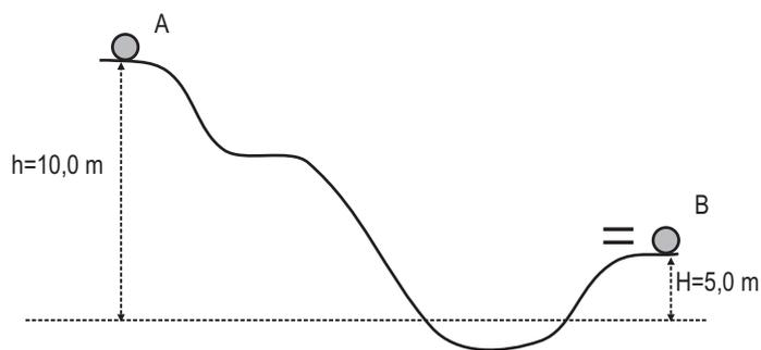
Um corpo é solto do ponto A, partindo do repouso, de uma altura de 10,0 m, percorrendo, sem atrito, o caminho mostrado na figura acima. Qual a velocidade ao passar pelo ponto B, situado a uma altura de 5,0 metros em relação ao chão?
