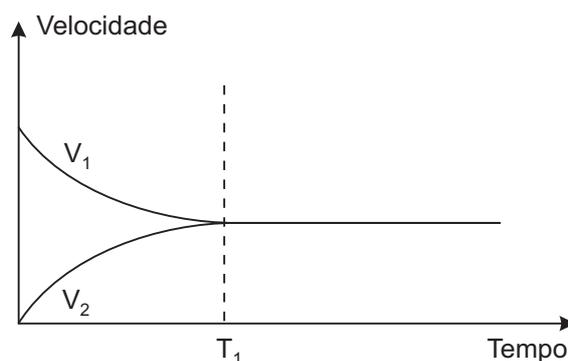
De acordo com esse diagrama, o equilíbrio da reação é atingido no instante  $T_1$ , quando a relação entre a velocidade da reação de consumo dos reagentes ( $V_1$ ) e a velocidade da reação de formação dos produtos ( $V_2$ ) passa a ser
