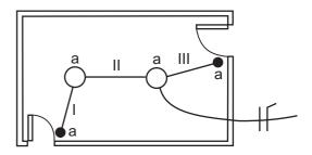
Para que os dois pontos de luz sejam acesos/apagados simultaneamente por qualquer um dos interruptores, a quantidade de condutores nos trechos I, II e III, de forma que seja utilizada a menor quantidade/comprimento de condutores, é, respectivamente,
