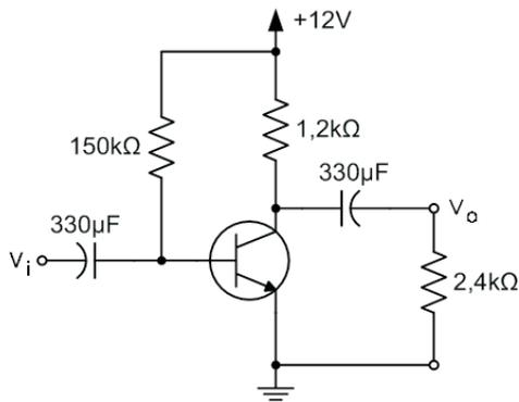
Dados do transistor:  $\begin{cases} h_{fe} = 120 \\ h_{ie} = 1 \text{ k}\Omega \end{cases}$
