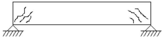
Essas fissuras surgem por causa da insuficiência de armadura para
