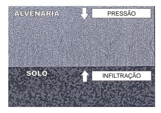
A umidade observada na parede da edificação, vinda de baixo e subindo até uma altura de aproximadamente 50 cm, provoca manchas escuras e descascamento. A natureza da infiltração decorre de
