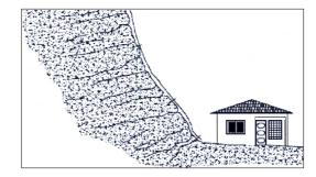
A situação apresentada acima configura um talude com grande inclinação, posicionado a uma distância de 3 metros do alinhamento lateral da edificação, onde o processo de erosão e precipitação desse talude sobre o platô já foi desencadeado. Neste caso, uma solução viável é:
