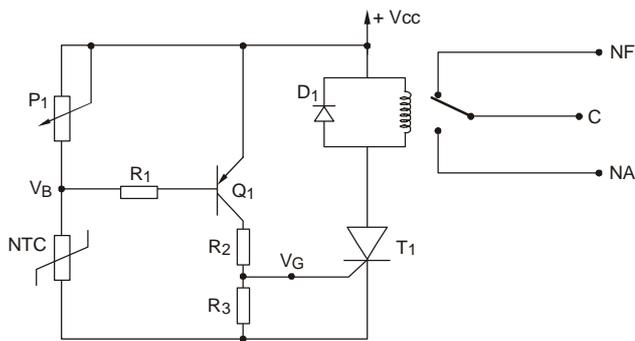
"Quando a temperatura ....., a resistência do NTC ....., de modo que a tensão  $V_B$  ....., ..... o transistor. Com isso, a tensão  $V_G$  ....., disparando o SCR e acionando o relé."
