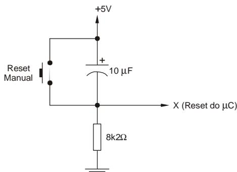
"Ao ligar a alimentação do circuito, a saída X passa imediatamente para nível lógico ....., isto é, ....., ativando automaticamente a entrada *reset* do microcontrolador. Após aproximadamente ....., a saída X muda para nível lógico ....., desativando o *reset*."
